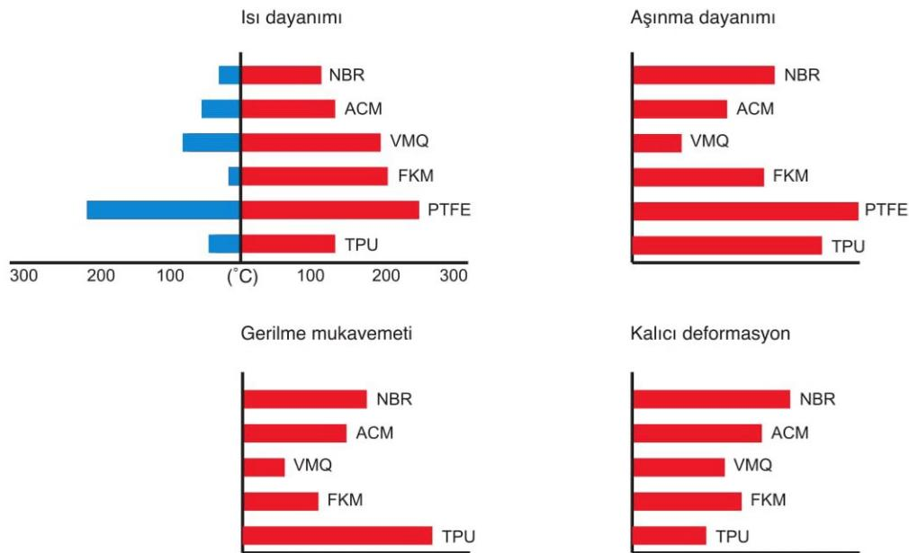
\* Kalıcı deformasyon grafiği elastomerin plastik deformasyona direnci göz önünde bulundurularak hazırlanmıştır.
