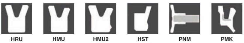
\* Döner mil keçeleri için sadece standart profil tipleri gösterilmiştir. Özel uygulamalar için farklı tipte pek çok Suptex® ürün profili bulunmaktadır.
